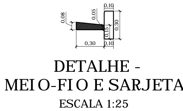
DETALHE - MEIO-FIO E SARJETA ESCALA 1:25
